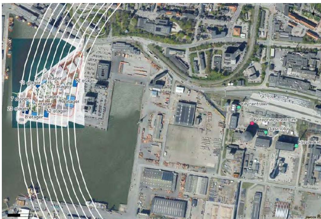
Figur 9.1 - Receptornet anvendt i OML-beregningerne (hvide streger). Beregningscentrum er angivet med pink prik. Afkast fra Citycentralens reservelastcentral, gasmotor og flisværk er angivet med grønne prikker. Projektområdet er markeret med rød streg og projekterede antal bygningsetager er angivet.
