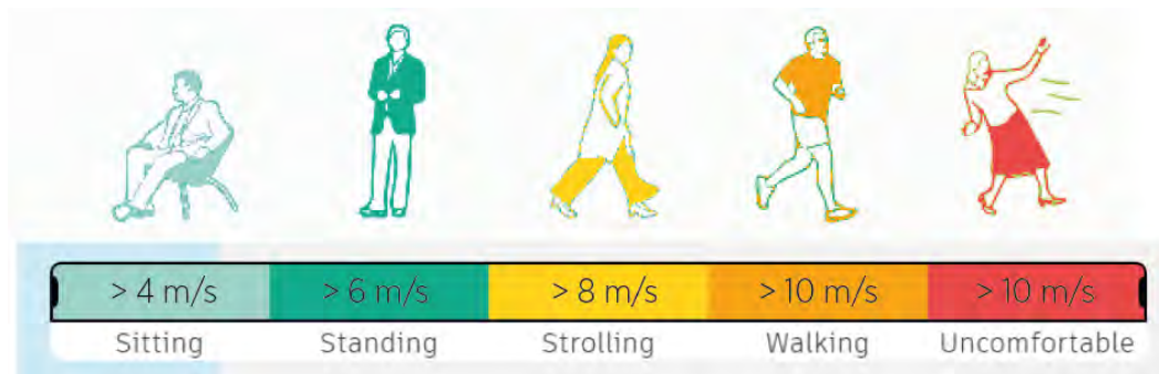
Figur 13.1, Lawson Skalaens kriterier for vindkomfort som simuleringerne er udført med
